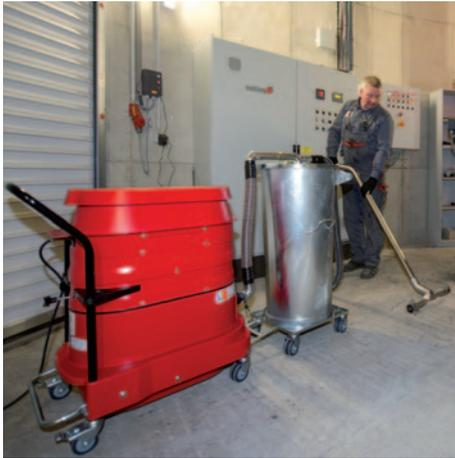
WS 2220 с предварительным сепаратором 110л
