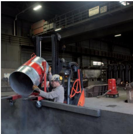
Предварительный сепаратор 200л с системой опрокидывания
