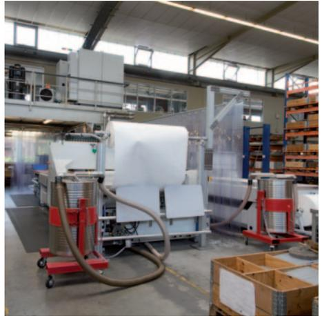
Предварительный сепаратор 200л с системой опрокидывания
